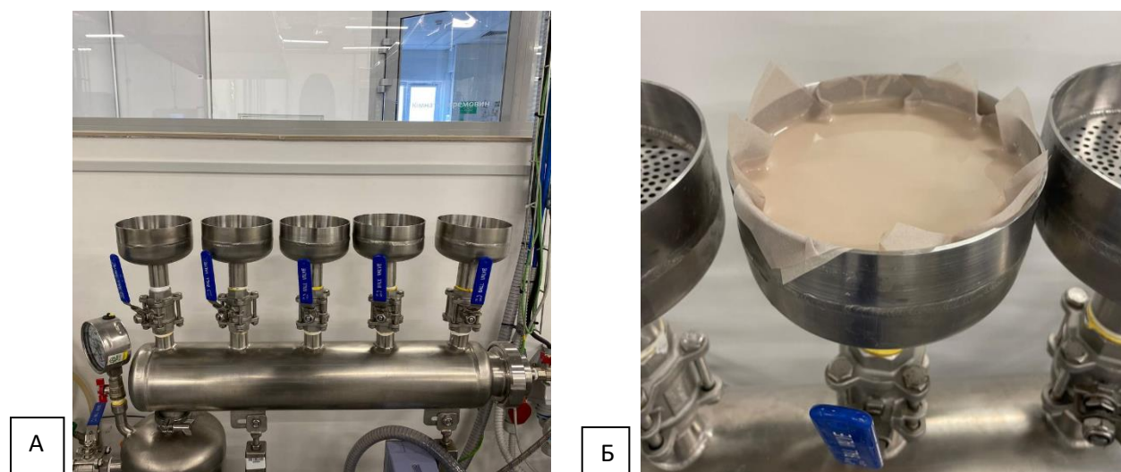
Рис. 2.9: а) Вакуум-фільтр; б) зразок дріжджів в процесі вакуум-фільтрації
