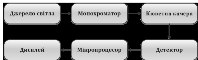
Рис. 5. Спектрофотометр Granum 722 та блок-схема спектрофотометра
