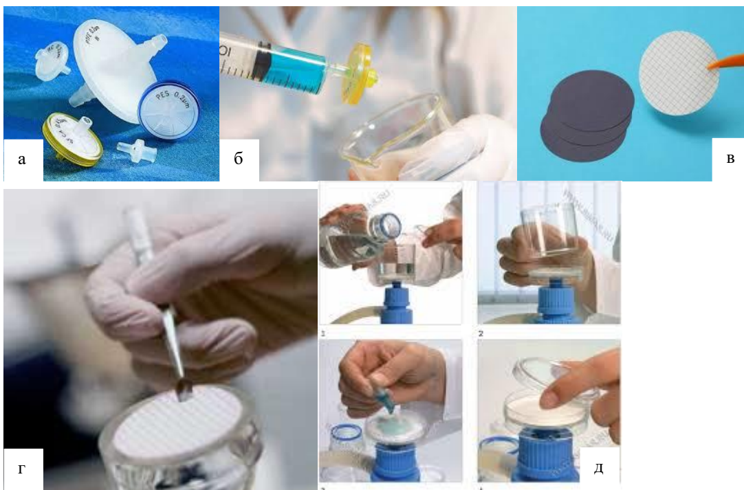
Рис. 10. Різновиди фільтрів а – шприцеві фільтри; б – використання шприцевих фільтрів; в – мембранні фільтри; г, д – використання мембранних фільтрів.
