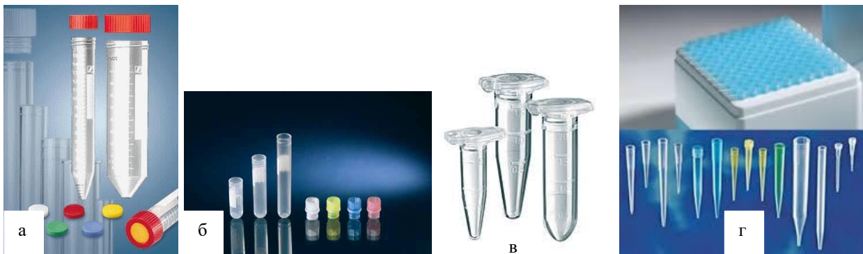
Рис. 9. Пластиковий посуд: а – центрифужні пробірки різного об’єму; б – пробірки для кріоконсервації клітин; в – мікропробірки Епандорф; г – наконечники для мікродозаторів.
