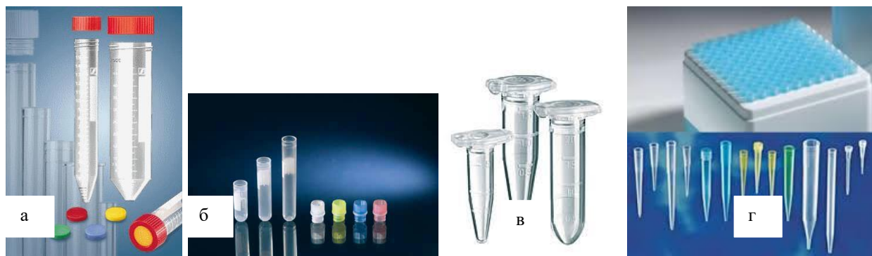
Рис. 10. Пластиковий посуд: а – центрифужні пробірки різного об'єму; б – пробірки для кріоконсервації клітин; в – мікропробірки Епендорф; г – наконечники для мікродозаторів.
