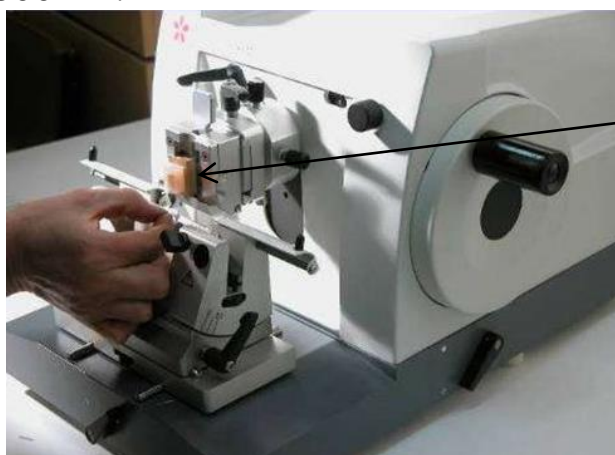
Рис. 3. Мікротом – прилад для отримання зрізів
