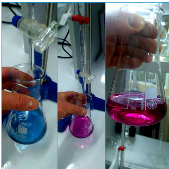
Рис. 3. Визначення загальної жорсткості води
