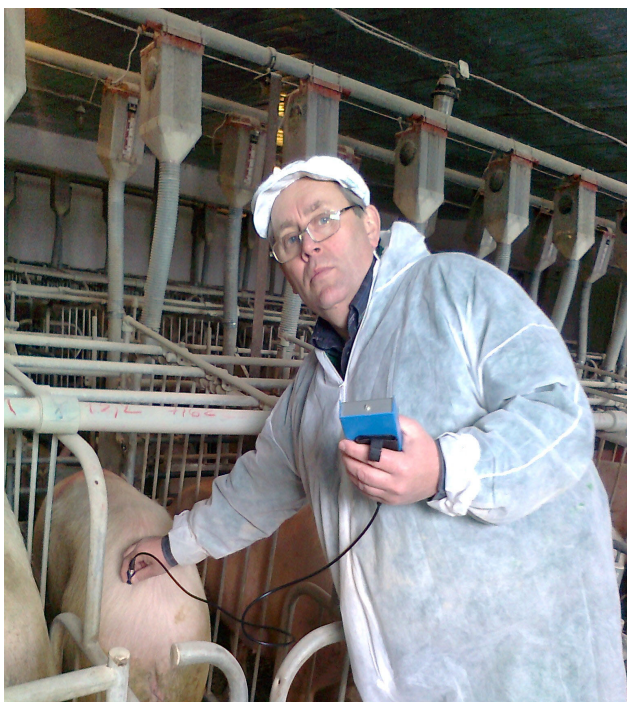
Рис. 1. Вимірювання товщини шпигу приладом RENKO CE ( RENKO LEAN MEATER DIGITAL BACKFAT IDIC, S/N 46080).
