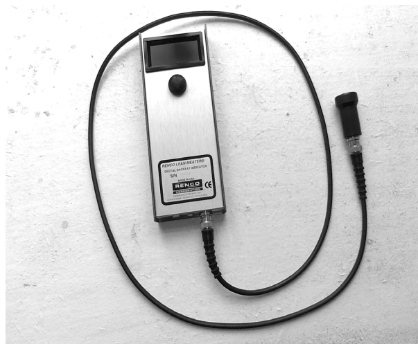
Рис. 1. Вимірювання товщини шпигу приладом RENKO CE ( RENKO LEAN MEATER DIGITAL BACKFAT IDIC, S/N 46080).
