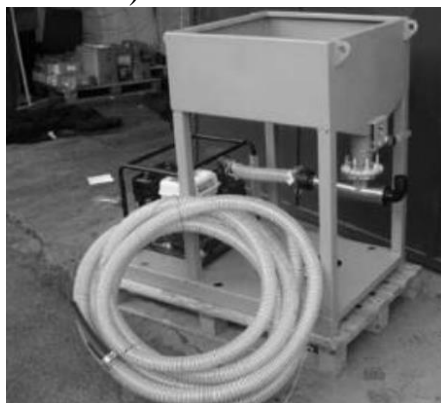
Рис. 15.12. Гідрокормороздавач JET 100B
