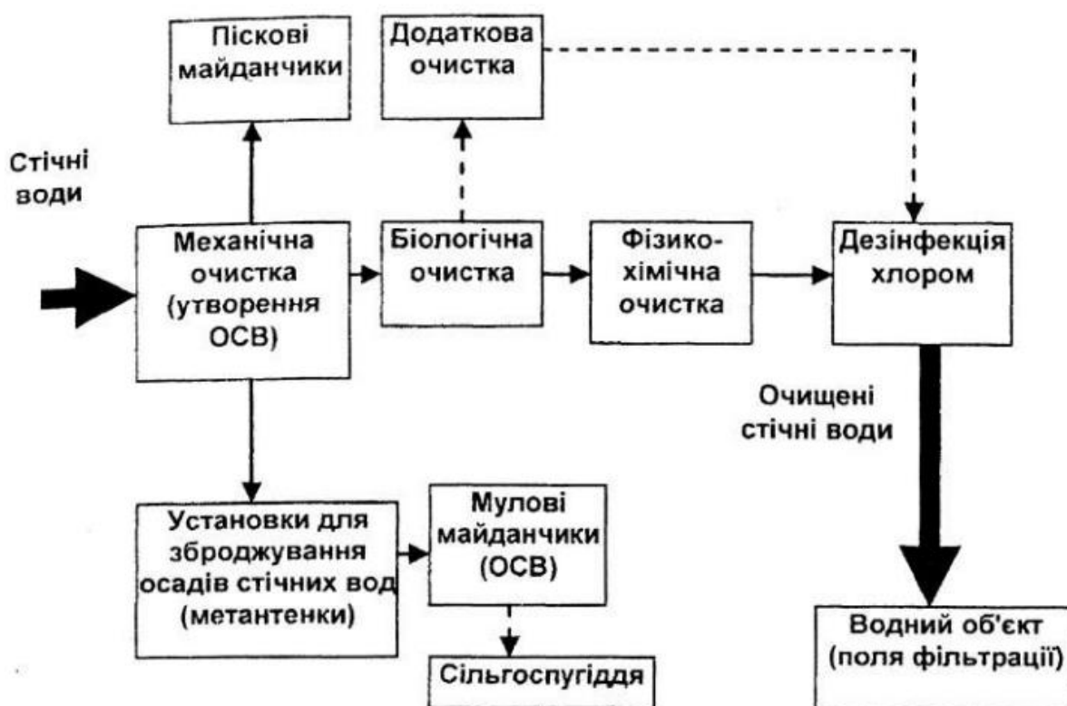
Рис. 3.1. Загальна схема очистки стічних вод на досліджуваних очисних спорудах
