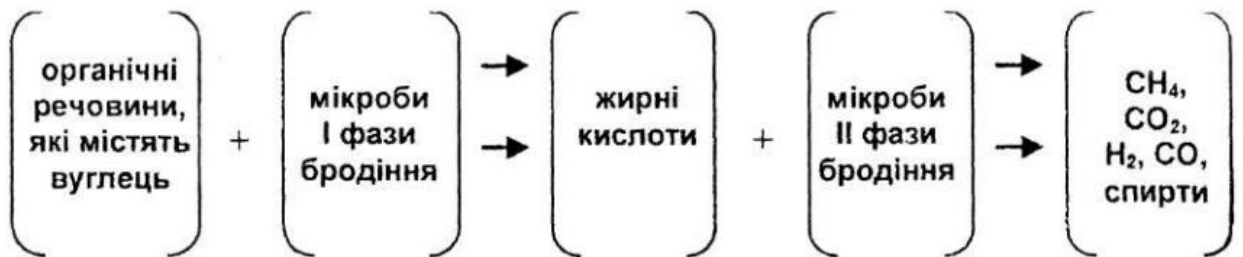
Рис. 3.8. Схема мікробного бродіння за анаеробних умов
