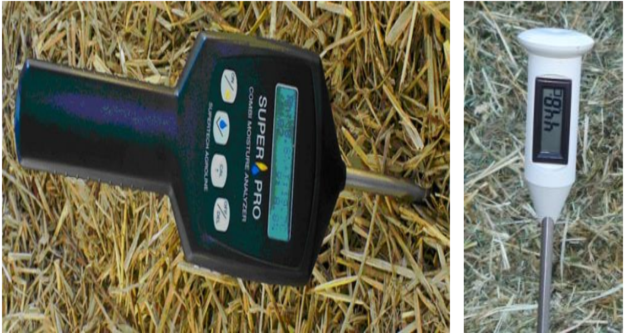
Рис.13.14. Вологомір та шуп-термометр для оцінки сіна
