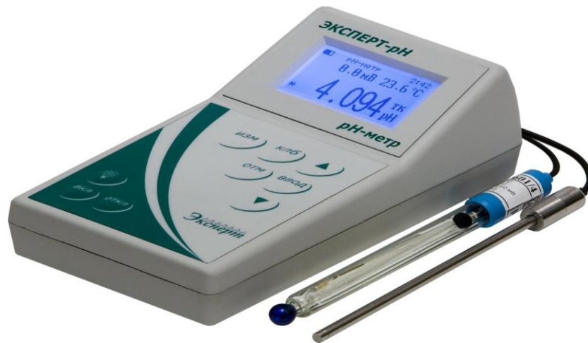
Рис.24. Прилад для визначення рН корму
