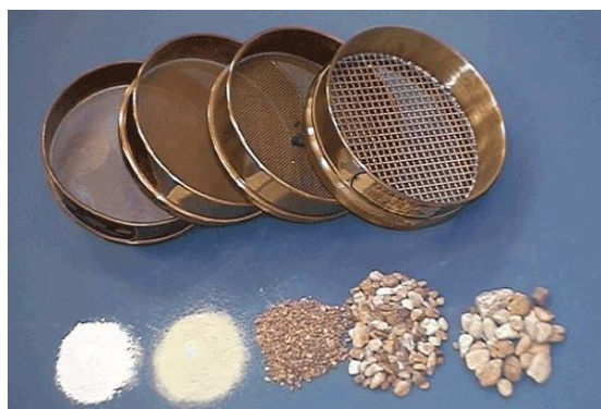
Рис.22,23. Сита для визначення засміченості зерна
