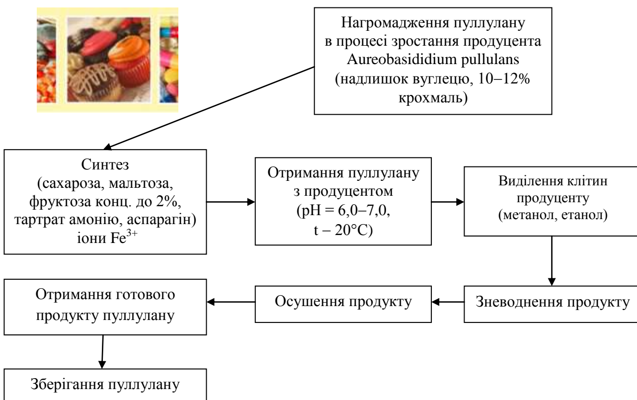
Рис. 5.67. Схема отримання пуллулану з дріжджоподібного гриба Aureobasidium pullulans
