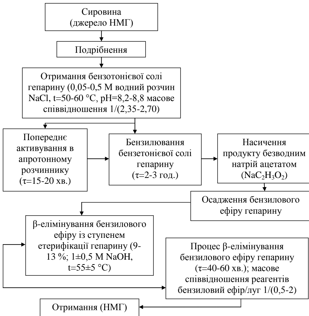
Рис 1.39. Загальна технологічна схема отримання НМГ
