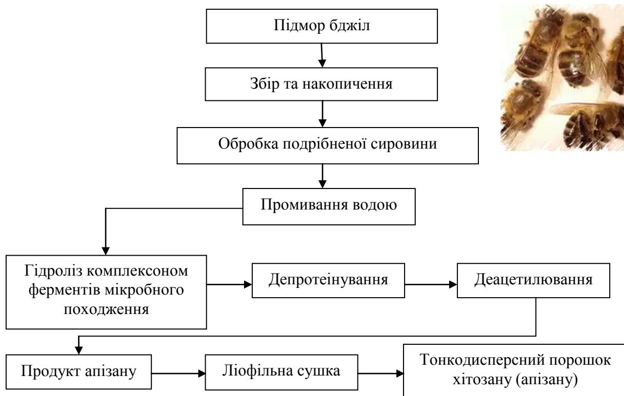
Рис. 6.21. Виробництво хітозану (апізану) з підмору бджіл
