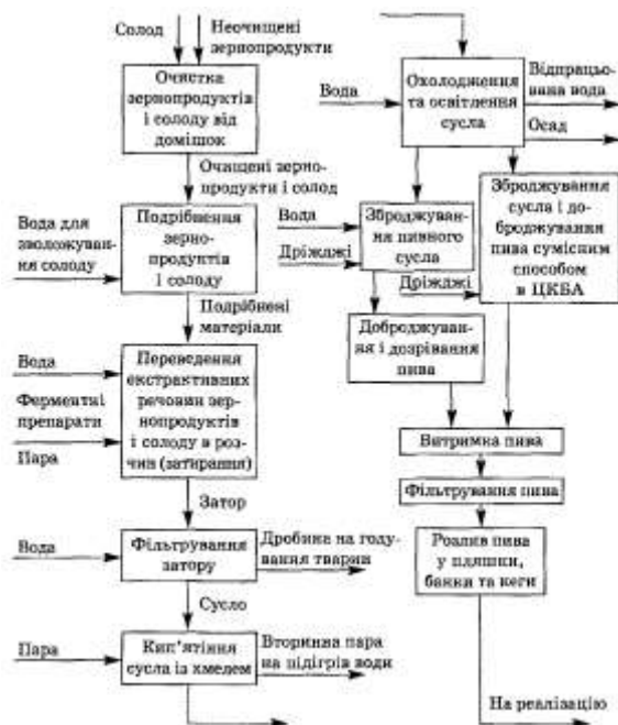
Рис. 4.6. – Принципово-технологічна схема виробництва пива
