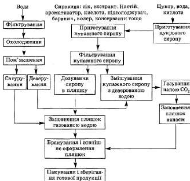
Рис. 4.19. – Принципово-технологічна схема виробництва безалкогольних напоїв
