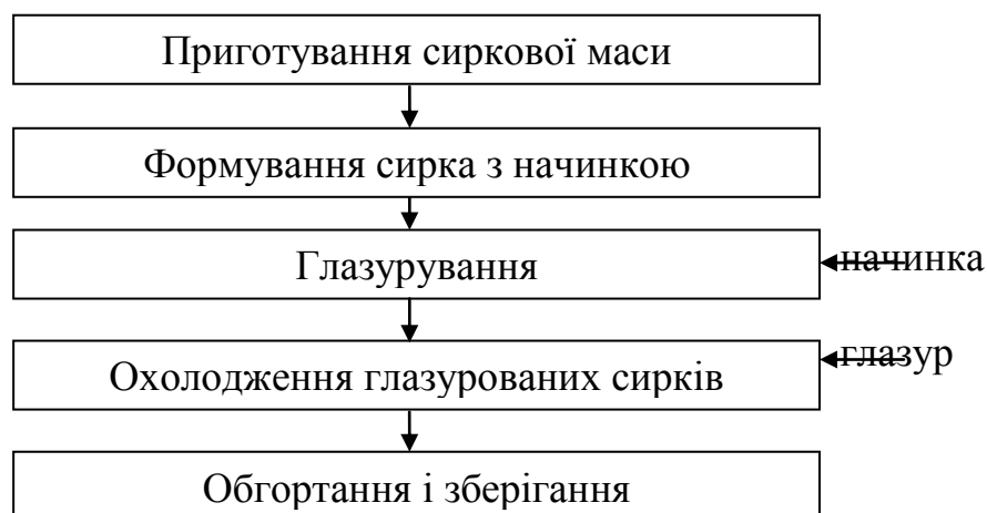
Рис. 2.7. Технологічна схема виробництва глазурованих сирків з начинкою
