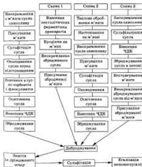
Рис. 4.16. – Принципово-технологічна схема одержання виноматеріалів для натуральних вин
