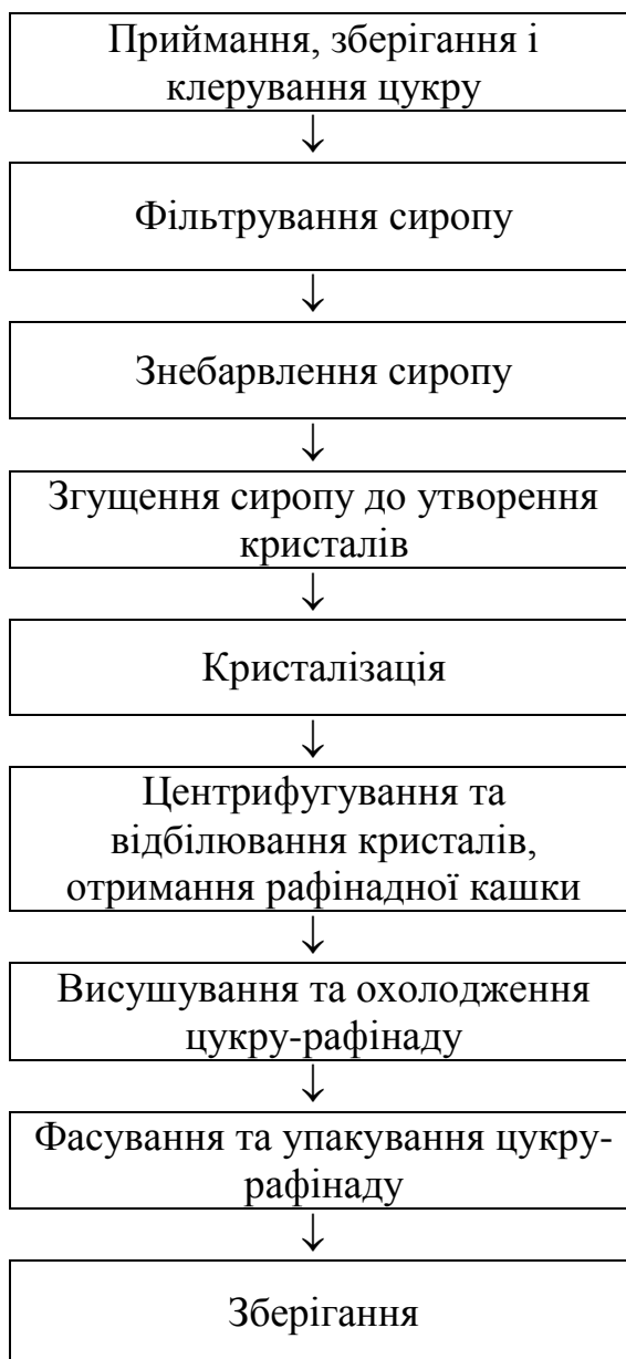
Рис. 1.2. Технологічна схема виробництва цукру-рафінаду
