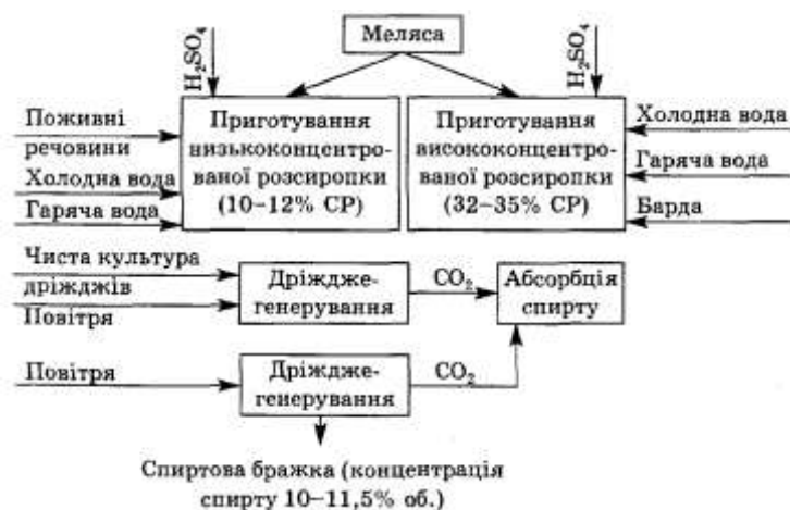
Рис. 4.10. – Принципова технологічна схема виробництва спиртової бражки з меляси
