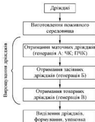
Рис. 4.5. Функціональна схема одержання дріжджів
