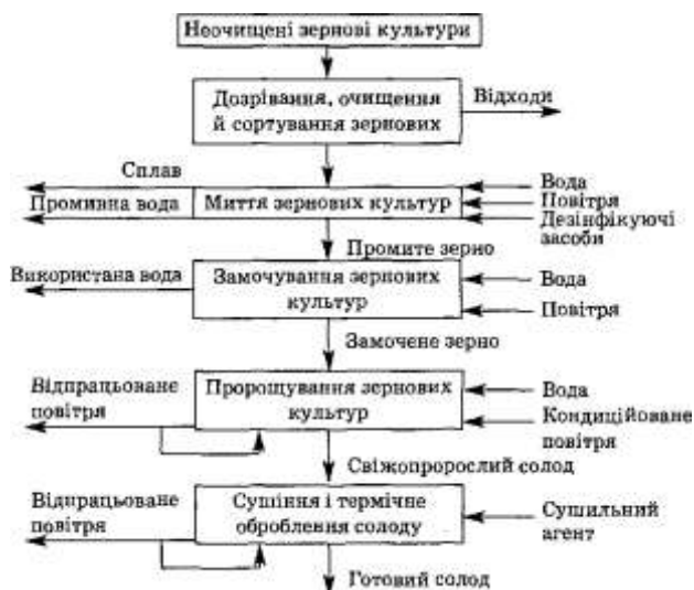
Рис. 4.1. Принципова технологічна схема виробництва солоду із зернових культур
