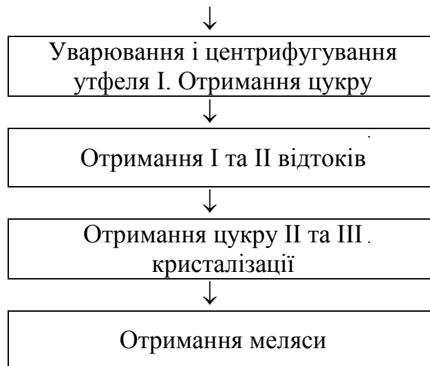
Рис. 1.3. Технологічна схема виробництва тростинного цукру із тростинного цукру-сирцю
