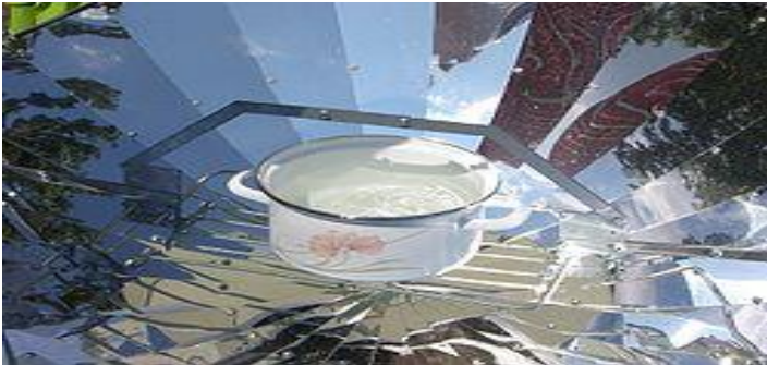
Рис.1.1. Фокусуюча нагрівальна установка
