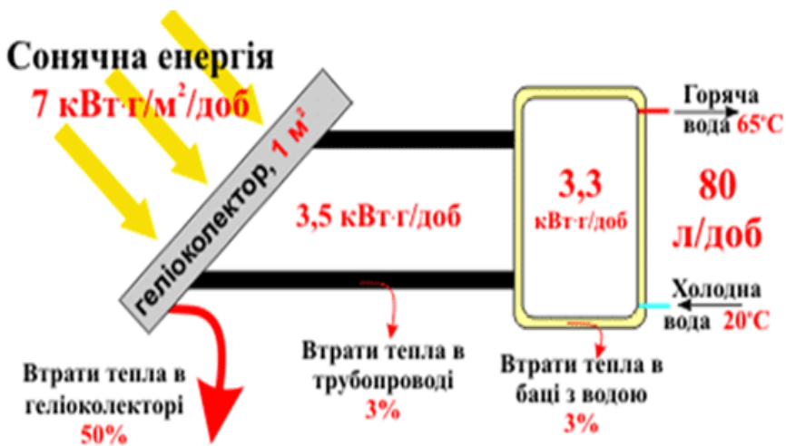
Рис.1.16. Баланс втрат енергії в геліосистемі
