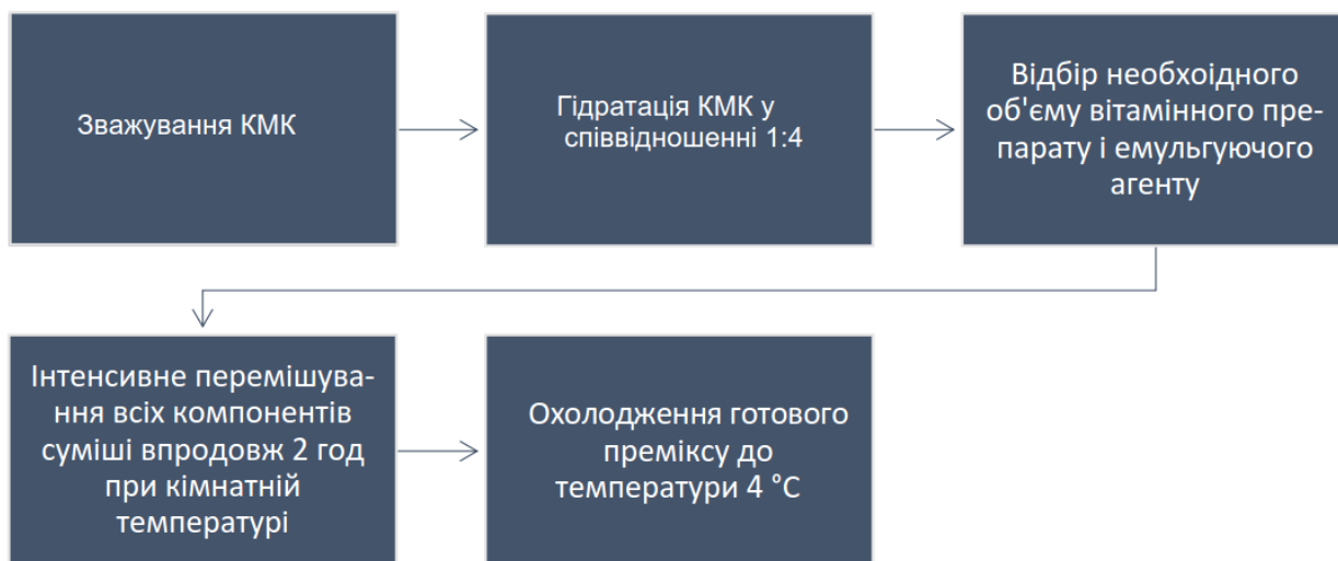
Рис. 6. Технологія приготування вітамінного комплексу на основі КМК
