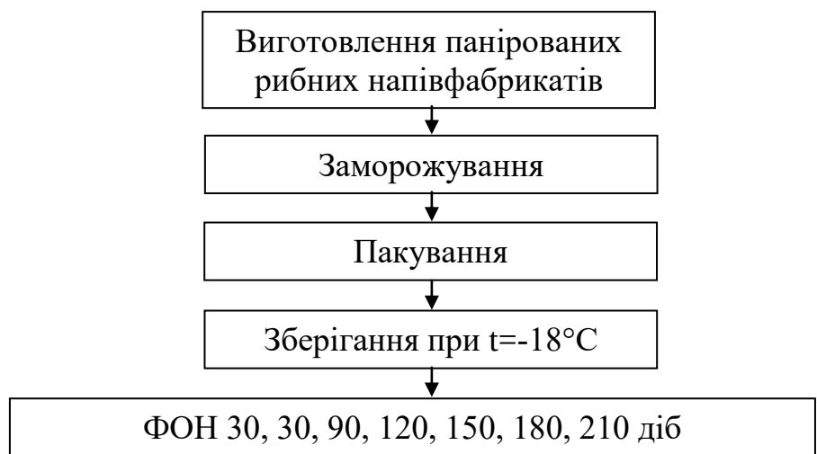
Рис. 3.10. Схема проведення експерименту з дослідження органолептичних показників якості панірованих рибних напівфабрикатів.
