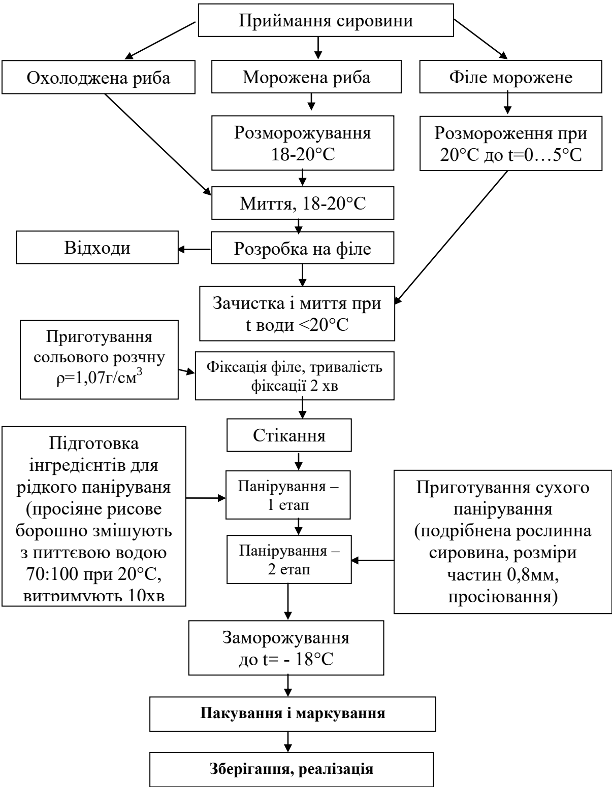
Рис. 3.15. Схема технологічного процесу виробництва панірованих рибних напівфабрикатів.
