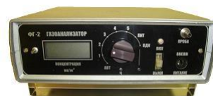
Рис.23. Універсальний фотоінізаційний газоаналізатор ФГ-2
