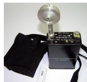
Рис. 16. Вимірювач масової концентрації пилу ИКП
