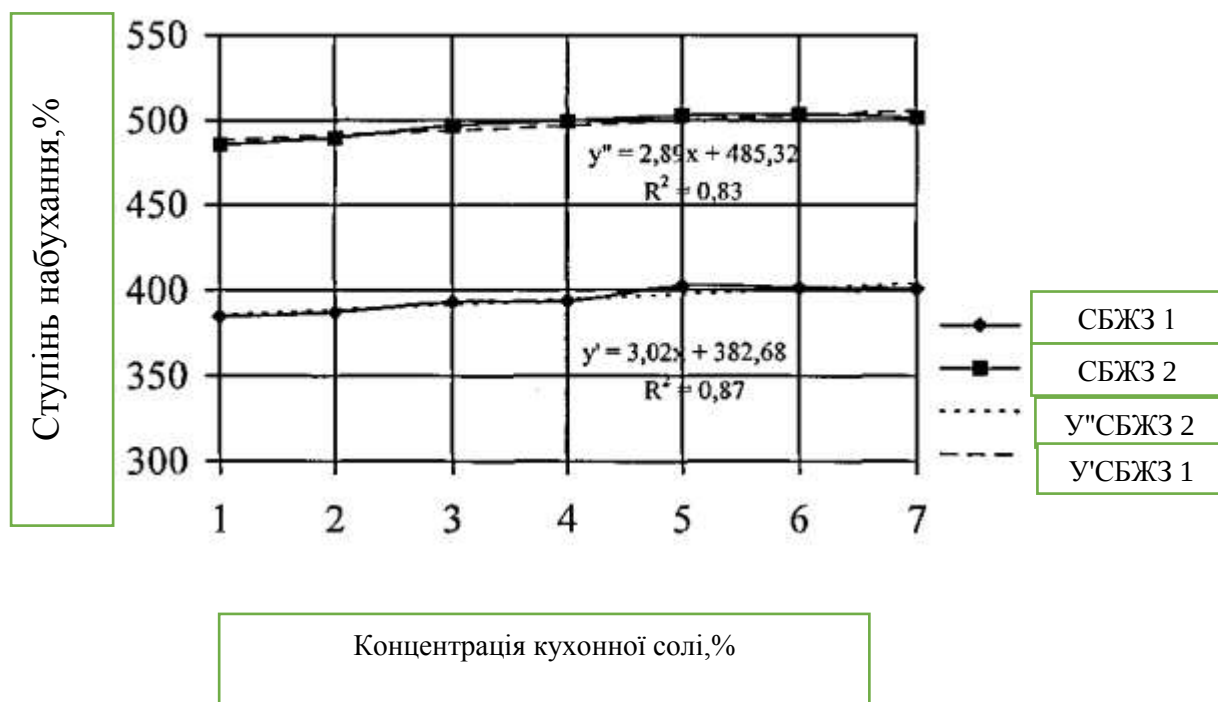
Рисунок 3.4 — Вплив концентрації NaCl на ступінь набухання білкових продуктів
