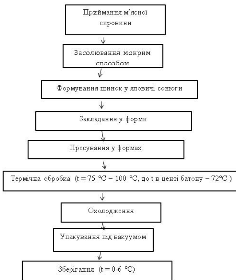
Рис. 3.5. Зображення технологічної схеми формової шинки
