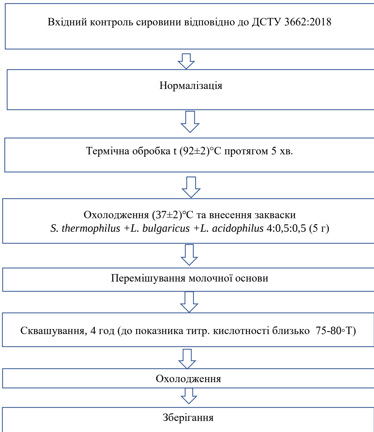
Рис. 3.2. Технологічна схема для виробництва йогурту
