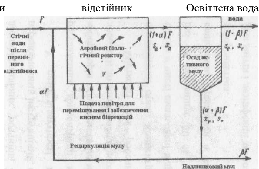
Рис. 19. Схема процесу аеробного очищення води за участі активного мулу [Дмс. Бейли, 1989 р.].
