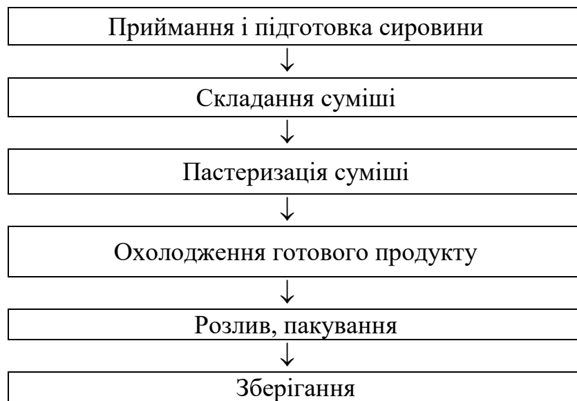
Рис. 2.3. Принципова технологічна схема виробництва молока з кавою нежирного
