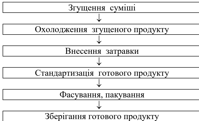
Рис. 2.7. Принципова технологічна схема виробництва нежирного згущеного молока з цукром
