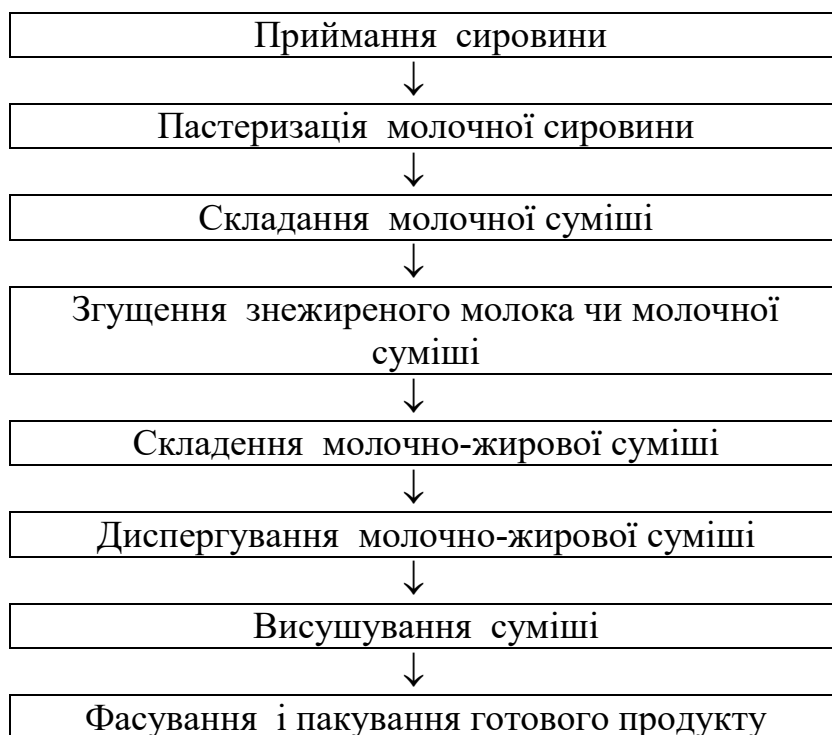
Рис. 4.1. Принципова технологічна схема виробництва ЗНМ-1
