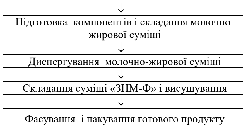
Рис. 4.3. Принципова технологічна схема виробництва сухого замітника незбираного молока «ЗНМ-Ф»
