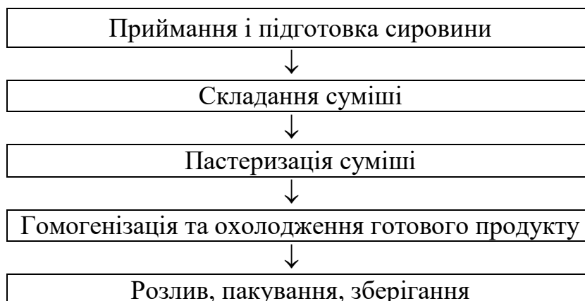
Рис. 2.2. Принципова технологічна схема виробництва молока з какао нежирного
