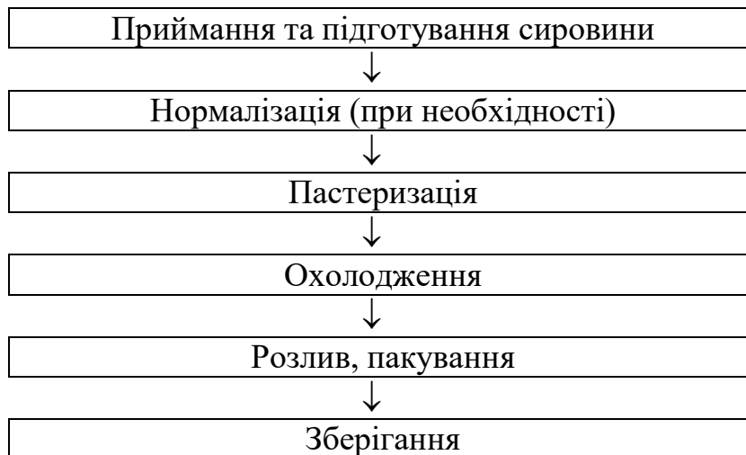
Рис. 2.1. Принципова технологічна схема виробництва пастеризованого нежирного та молочного молока
