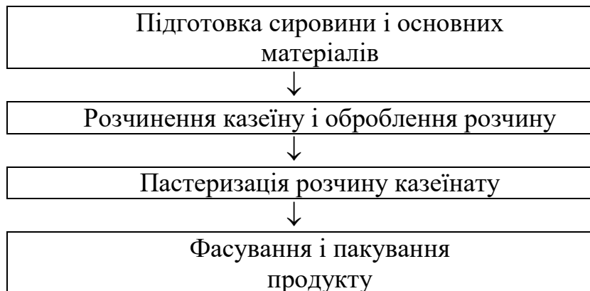
Рис. 3.9. Принципова технологічна схема виробництва рідкого харчового казеїнату натрію із сухого кислотного казеїну
