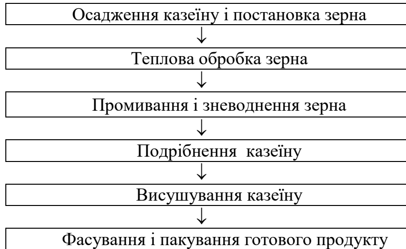
Рис. 3.3. Принципова технологічна схема виробництва казеїну сичужним способом
