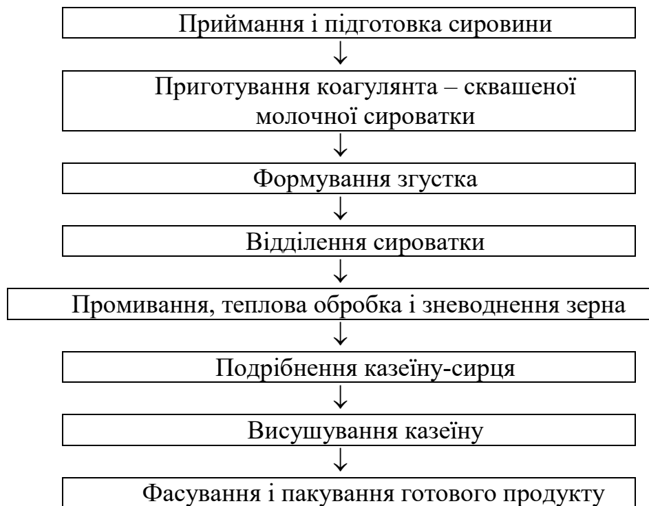
Рис. 3.4. Принципова технологічна схема виробництва казеїну безперервним способом
