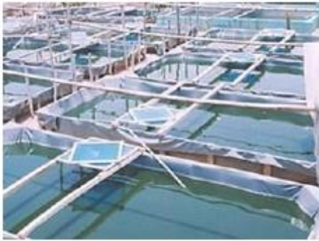
Рис.2 Біореактори для вирощування мікроскопічних водоростей: а – відкритого типу; б – трубчастий біореактор
