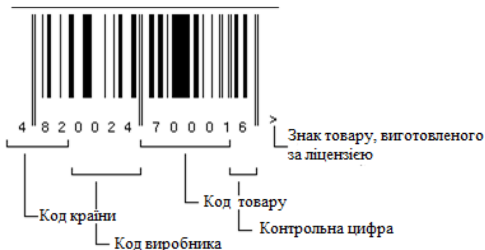
Рис. 1. Зразок штрихового коду в системі EAN-13
