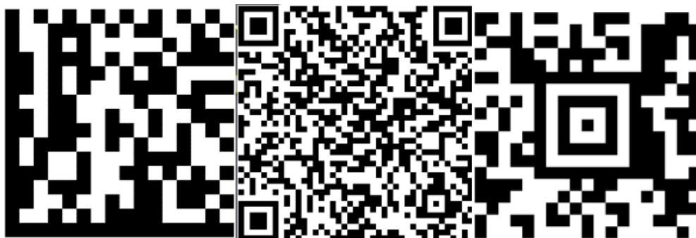
Рис. 2. Приклади кодів Data Matrix, QR-Code, Aztec
