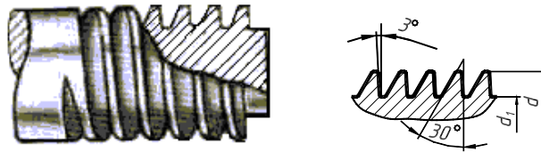
Рис. 8.10. Профіль упорної різьби.
